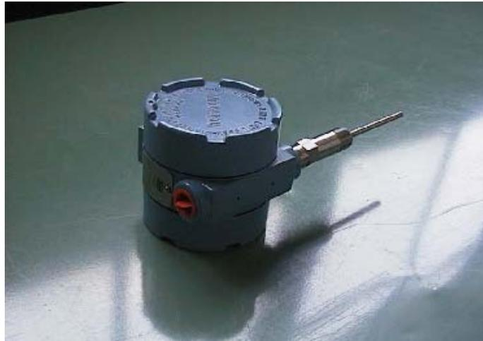
Figura 2.18 Sensor de temperatura utilizado en el sistema.
