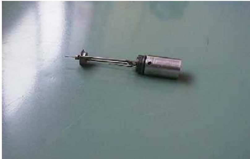
Figura 2.9 Sensores primarios de presión y temperatura y soporte de tarjetas electrónicas.
