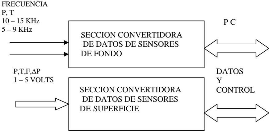
Figura 2.29 Diagrama general del convertidor de datos.
