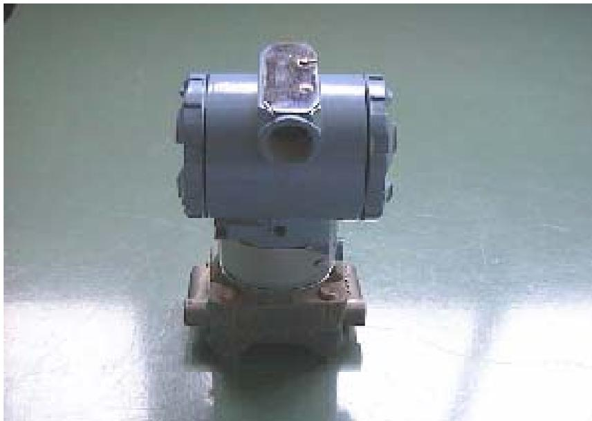
Figura 2.25 Sensor de presión diferencial utilizado en el sistema.
